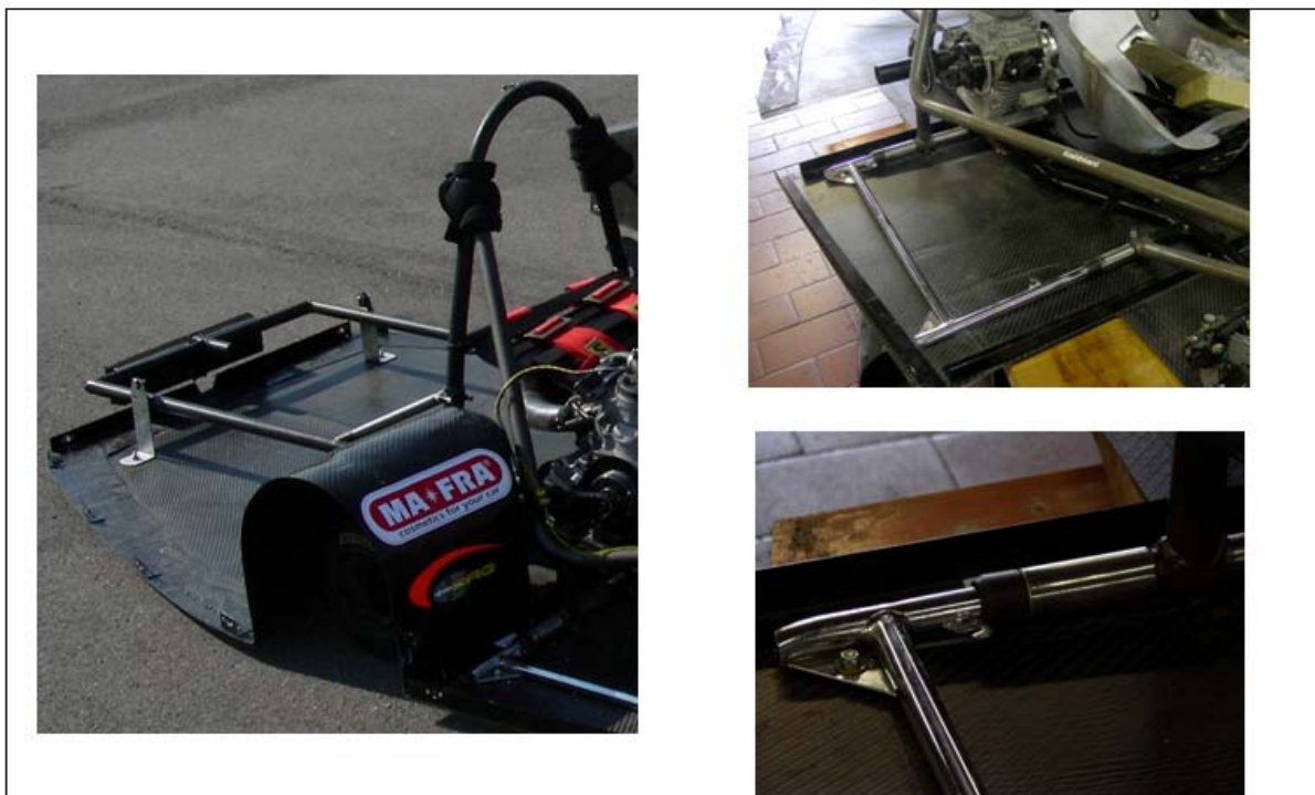
Figura 3: Soluzioni semplificate per il puntone posteriore e per il sostegno dei lati del fondo piatto
